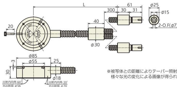
※被写体との距離によりテーパ照射及び平面照射の各光量調整により様々な光の変化による画像が得られます
