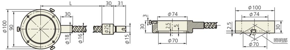
※照射端面がリングの中心軸に対して90°の角度の設定なので全周真横照射となり、立体的な画像が得られる
